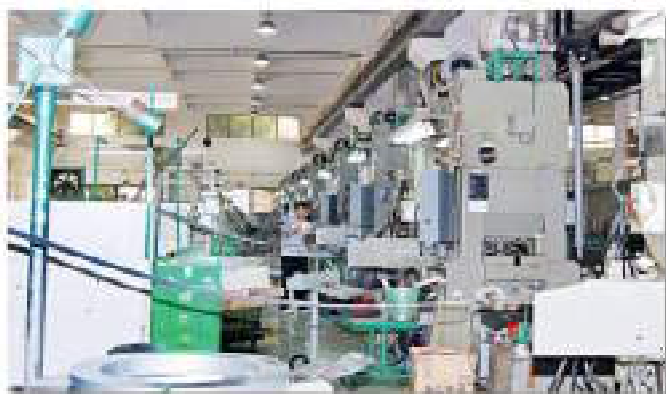
■トランスファープレス ステージ数: 12~14工程 能力: 45~200ton
