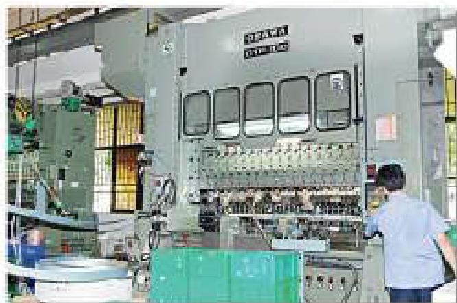
■トランスファープレス ステージ数: 18工程 能力: 100ton
