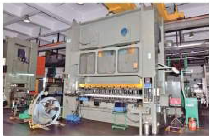
■トランスファープレス ステージ数: 14工程 能力: 400ton
